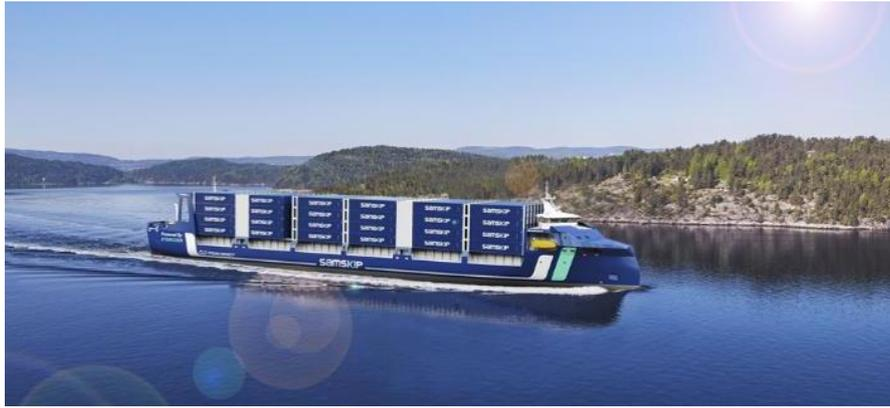
图 3-5 Samskip 500TEU 氢动力和远程控制的集装箱船
